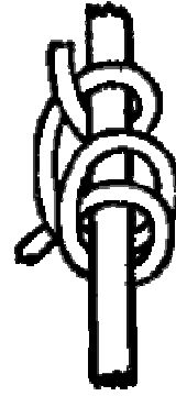
Ballestrinque doble. Se usa en sustitución del ballestrinque y para contra vientos.
