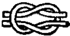
Nudo de Rizo, cuadrado o plano. Se usa para anudar vendajes y cuerdas del mismo grueso
