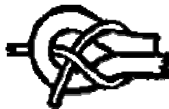
Vuelta de Escota. Para unir dos cuerdas del mismo o de distinto grueso.
