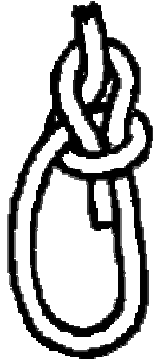
As de guía simple. Hace una gaza que no se corre. Nudo basico de anclaje que puede ser combinado en varios sistemas.
